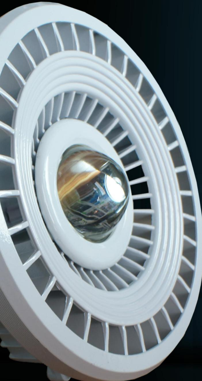
DOME(ドーム)シリーズは、工場や体育館などの高天井施設、駐車場や屋外灯などに最適なLED照明です。100V～200Vの直接入力が可能な電源内蔵式で設置が簡単。IP67の防塵・防水仕様で屋外でも使用できます。出力は60W～400Wまでの5タイプ、使用する場所や用途に合わせて幅広く対応できます。水銀灯は点灯後、所定の明るさになるまで10分程度が掛かりますが、LEDは電圧に対する反応が早く、点灯後約1秒で最大の明るさに達します。瞬時点灯・再点灯が可能で、休憩時間などにこまめな消灯ができ、節電に効果的です。食品工場などでは大敵な虫も来ません。長時間照明を点灯している場所や、たくさんの照明器具を設置している場所をLEDに替えれば、電気代・メンテナンスコストの大幅な削減を期待できます。また、電気代と共にCO<sub>2</sub>排出量も大幅に削減でき、水銀などの環境有害物質を使用していない為、環境にも優しく様々な施設に導入され始めています。
